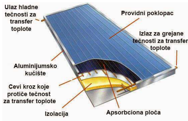
Слика 12.2: Плочасти соларни колектор
