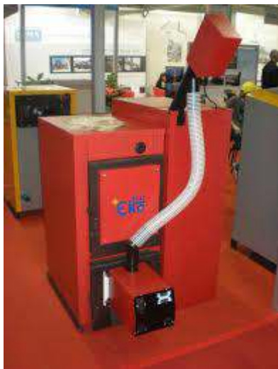
Слика 12.12: Котао на биомасу – пелет, са гориоником и бункером за пелет (производ Еко Стар – Књажевац, Србија)
